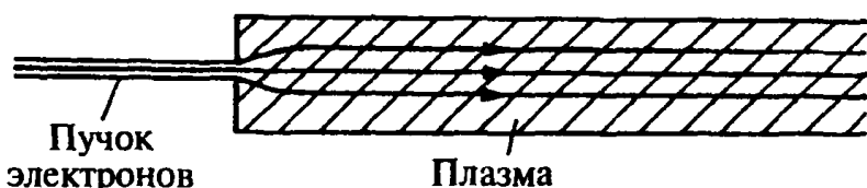
Рис. 4.16. Схема генерации плазменных волн в электронном пучке, проникающем в плазму
